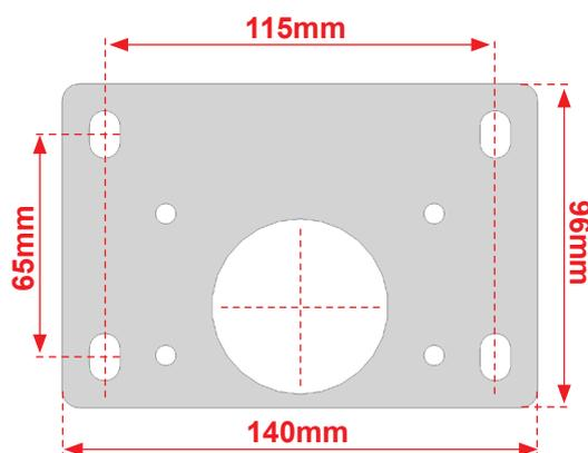
**Fixer les platines au niveau de chaque plot béton réalisé auparavant par deux vis minimum.**
