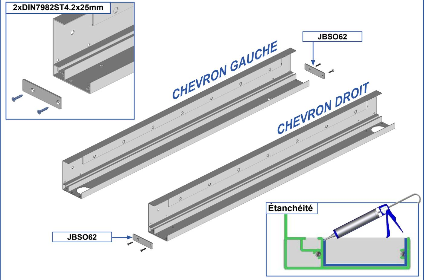
**6** Pose des bagues sur les chevrons supports de lame.
