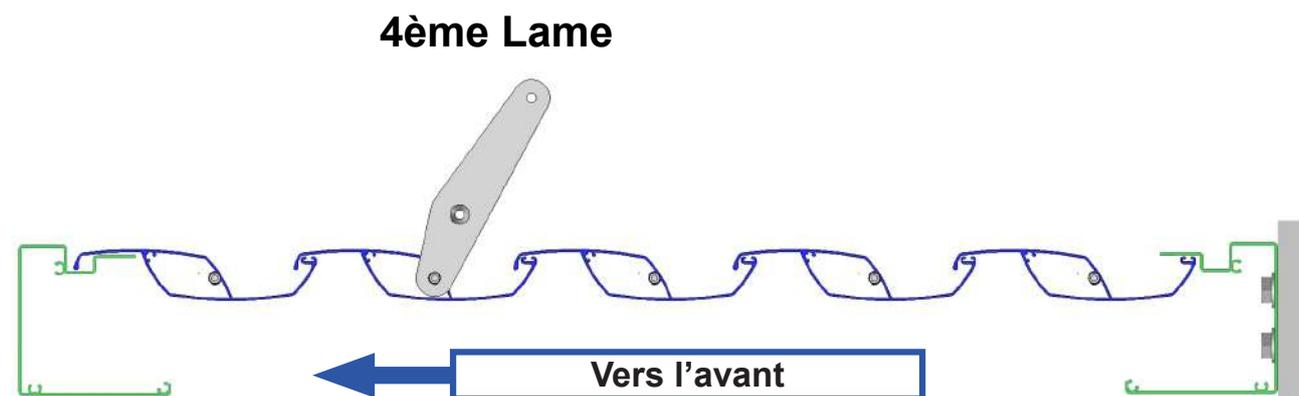
22 Pose de la tringle de manœuvre côté treuil. Fixation lames ouvertes.
