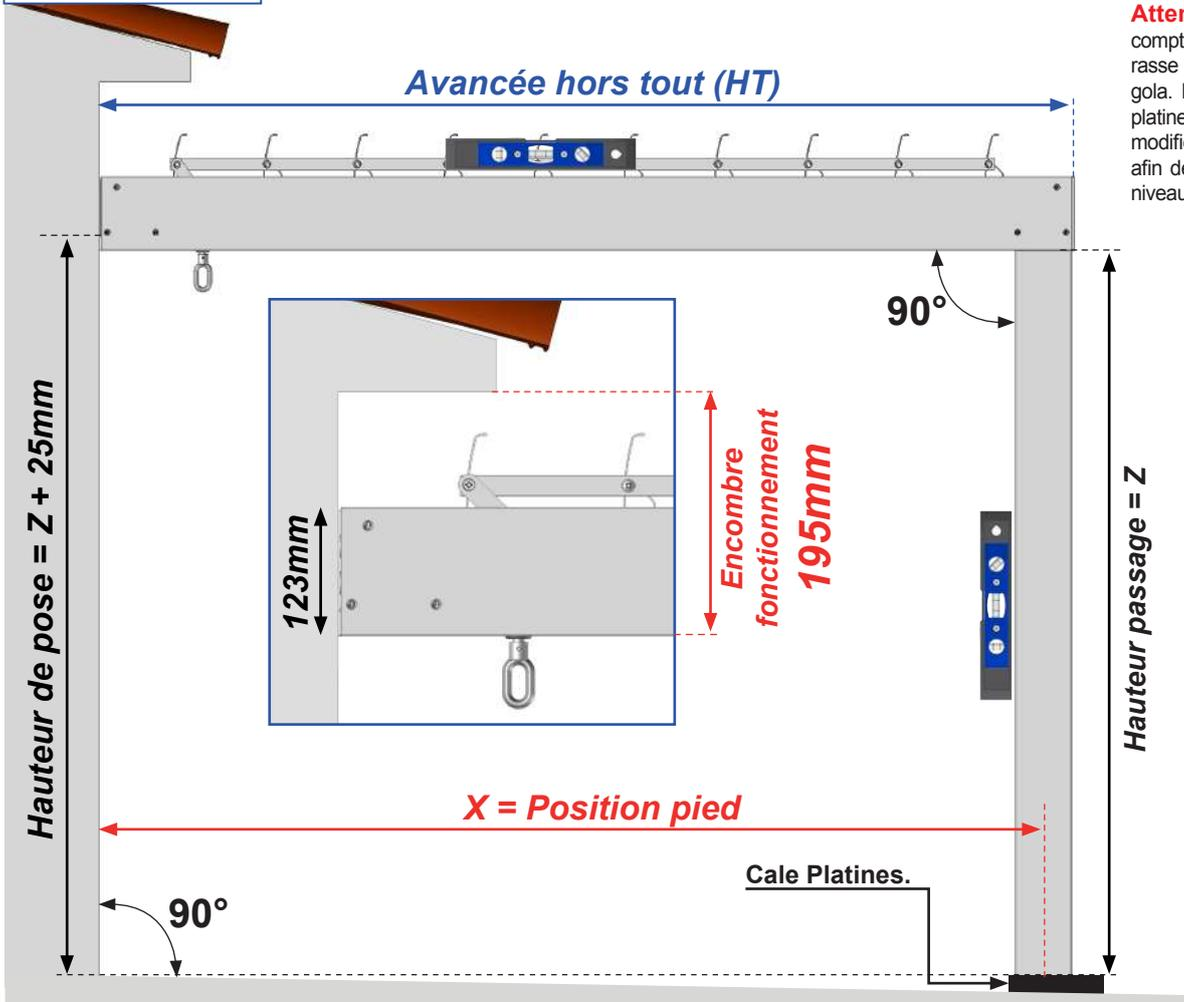
**Attention,** prendre en compte la pente de votre terrasse pour la pose de la pergola. Réaliser un calage des platines de fixation au sol ou modifier votre hauteur de pose afin de mettre la structure de niveau à 0°.
