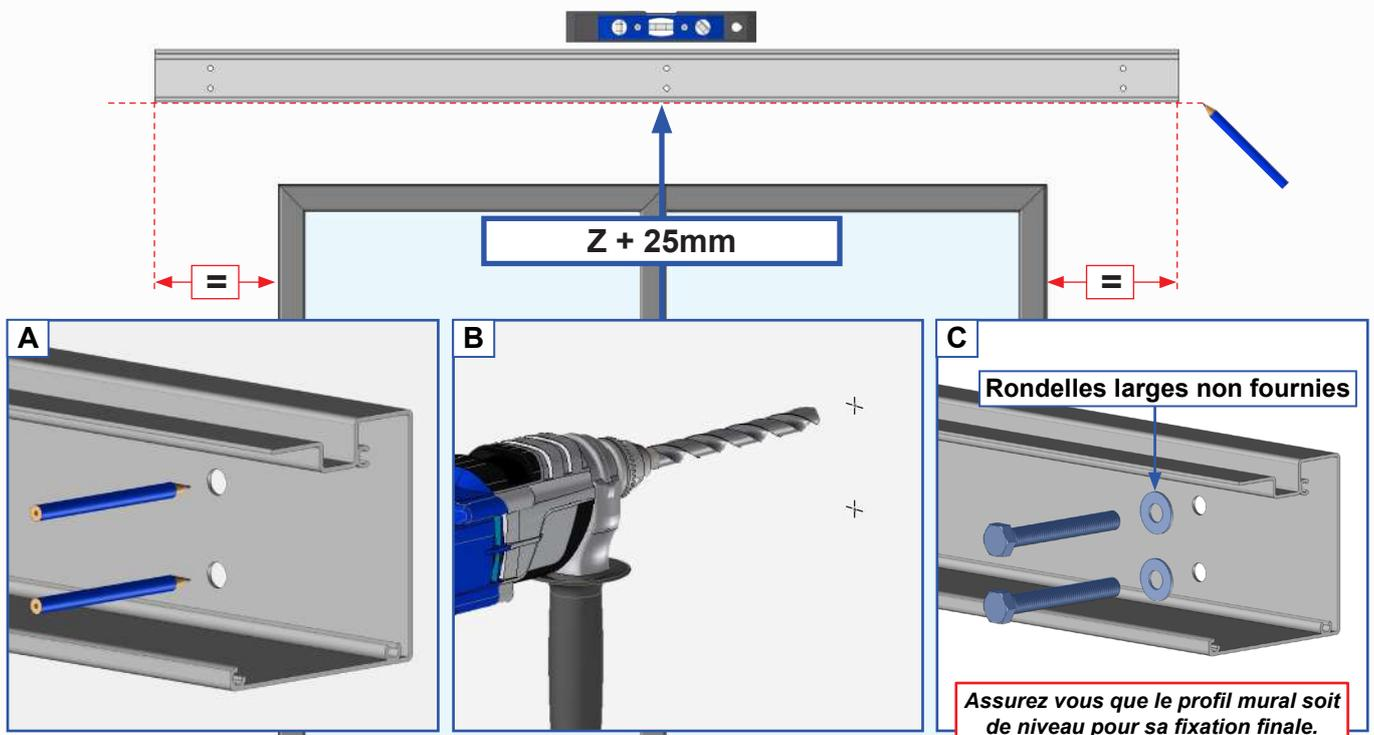
**Adapter la fixation à la nature du mur. Fixation avec des vis Ø8mm. Kit de vis et rondelle non fournis. Dans le cas d'installation à l'aide d'un kit de scellement chimique, se référer aux instructions d'utilisation du produit utilisé.**
