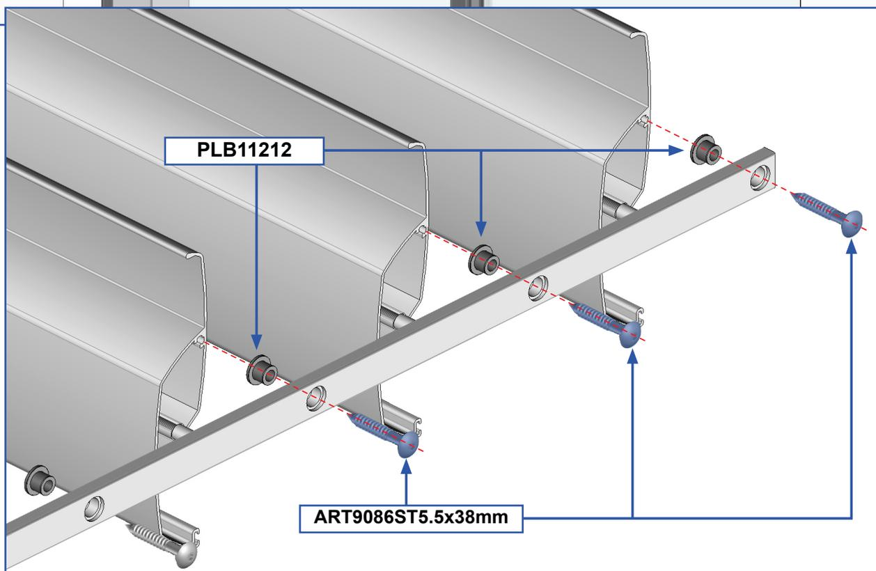
**25 Pose de la tringle de manœuvre côté droit. Fixation lames ouvertes.**
