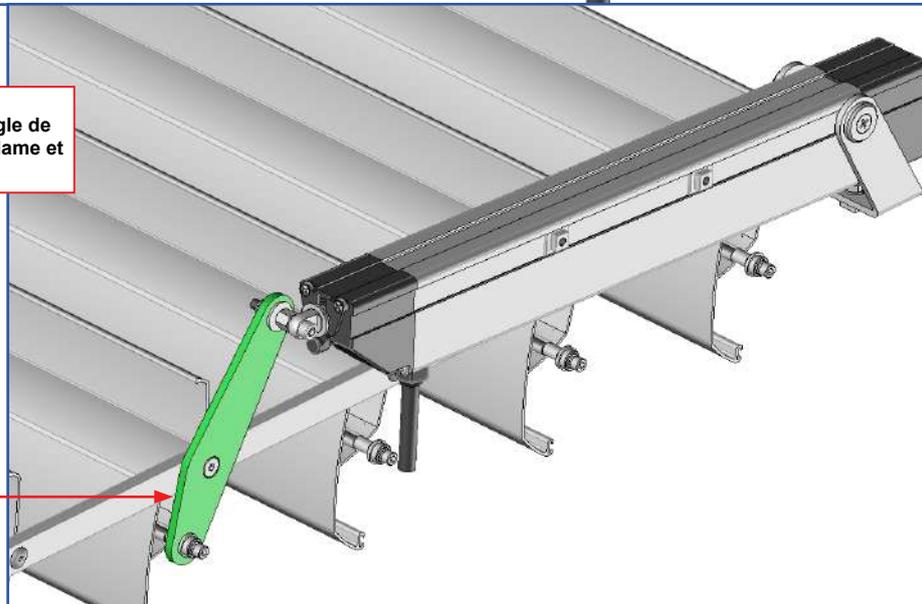
24 Pose de la tringle de manœuvre côté opposé manœuvre. Fixation lames ouvertes.
